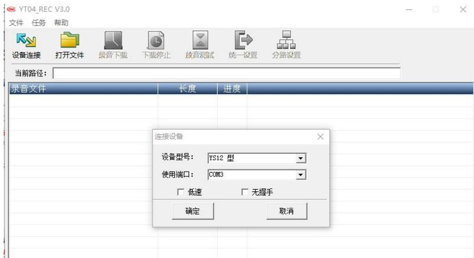
**注：**1、若端口未能正常连接，检验端口选择是否正确，是否正确接线。可尝试模块重新上电，软件重启等操作，直至显示为【已连接】再进行后续操作。
