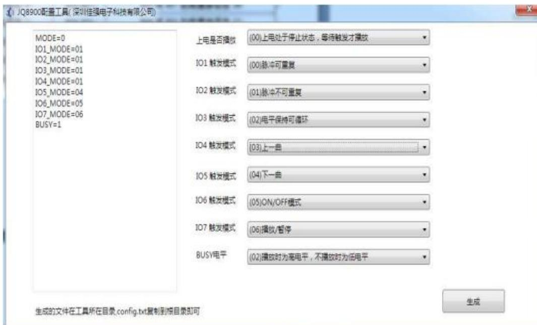
对每个 IO 口进行配置好后，点生成，就自动在配置工具所在目录生成一个 **config.txt** 文件，然后将 **config.txt** 文件复制到控制器所在的 U 盘即可。
