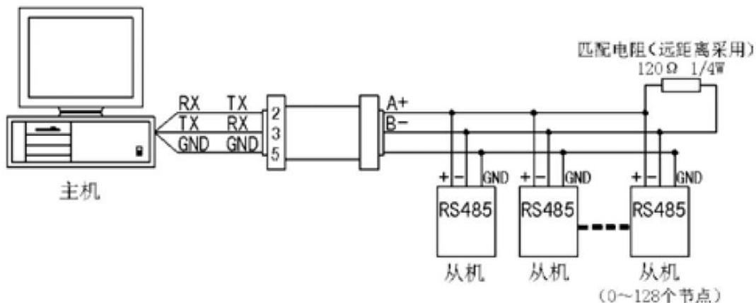
为防止信号的反射和干扰, 长距离传输时需在线路的终端加装匹配电阻。
